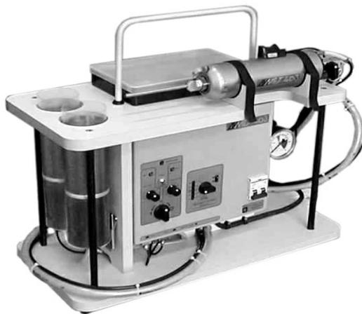
**Рис. 2. Установка газодинамического напыления «ДИМЕТ-405»**
