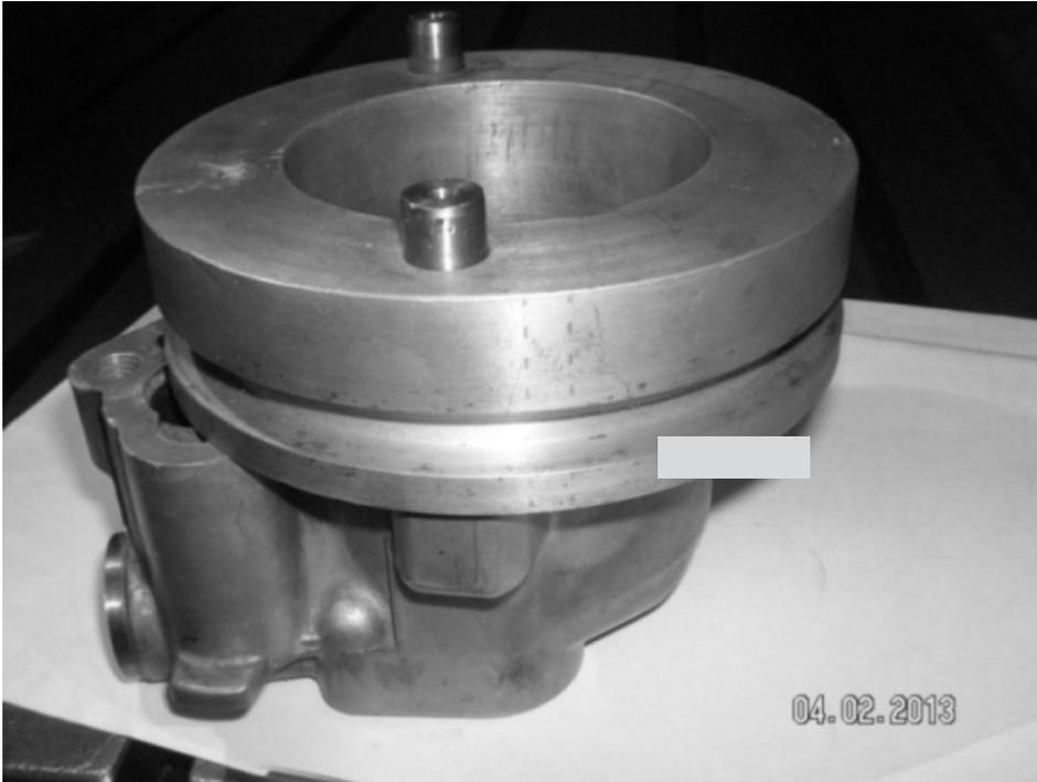
**Рис. 5. Оснастка для расточки колодца масляного насоса двигателя Caterpillar-3126**
